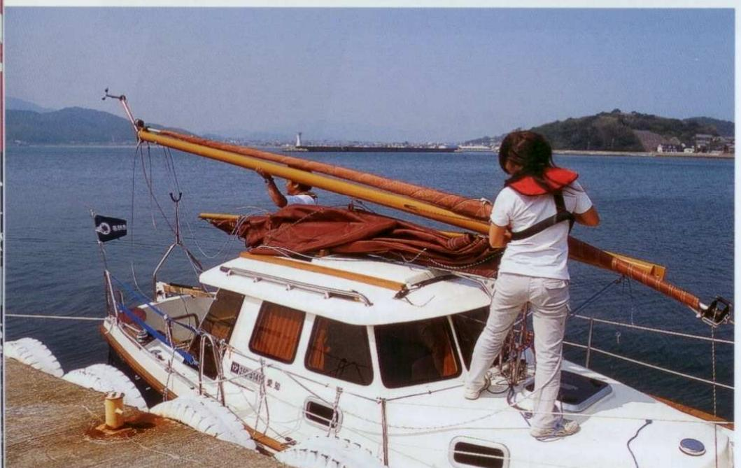
マストは通常は根元から起倒する方式が多いが、この船ではゲースネック付近を支点にマストを起倒する。マストとフォアステイの根元にリードされたロープを調整しながら、1人でも簡単にマストが倒せた
