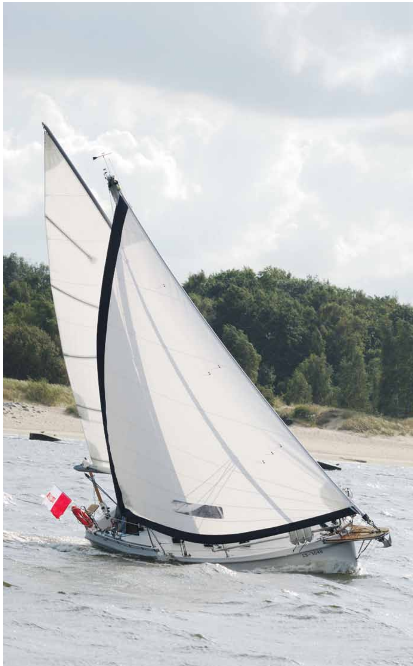
Haber 800 C4 posiada system czterech mieczy. Zanurzenie z podniesionymi mieczami – zaledwie 0,58 m.
