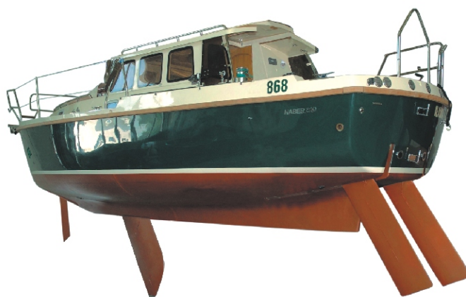
Ansicht mit allen abgesenkten Schwerter
